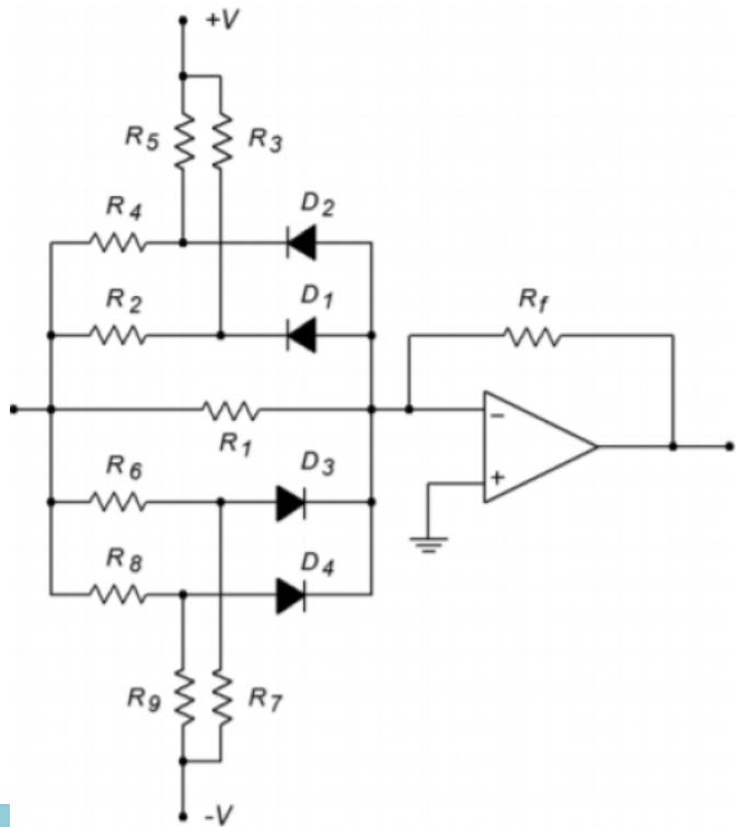
Diода  $D_3$  će provesti kada je napon na katodi jednak pragu provođenja  $V_\gamma = 0,7$  V. Odavde možemo Superpozicijom da odredimo prelomni napon,  $V_{break}$ .
