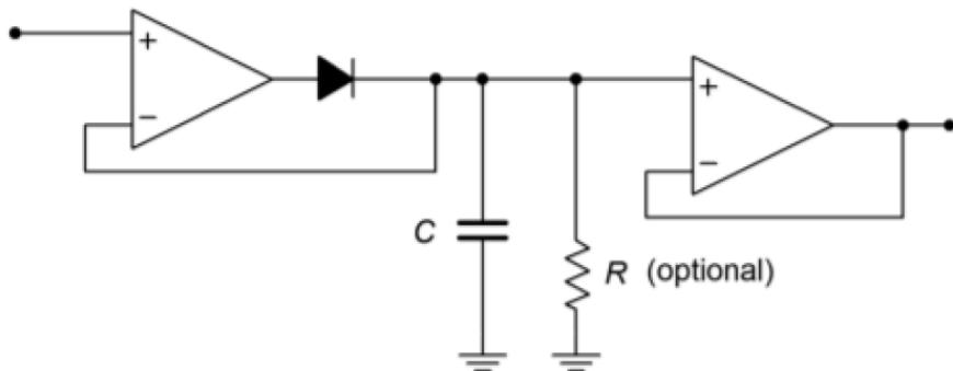
Adekvatni izbor otpornosti  $R$  i kapacitivnosti  $C$  omogućva da se napon na kondenzatoru ne smanji značajno tokom vremenskog intervala kada je napon negativan.
