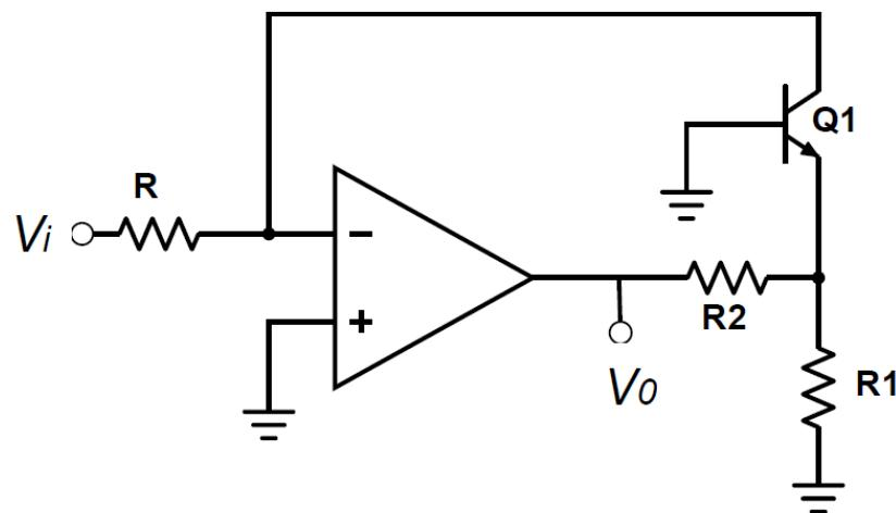
Naponskim razdelnikom koga čine  $R_1$  i  $R_2$  umanjuje se i kružno pojačanje. Efekat koji se ovim dobija je da je pri istoj vrednosti kružnog pojačanja dobija pojačana vrednost signala na izlazu.
